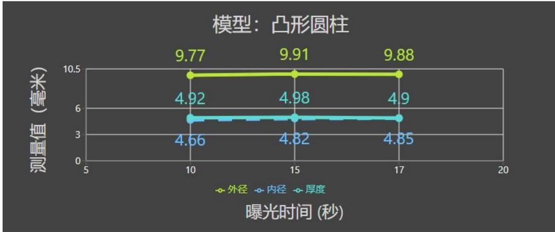
从凸形圆柱数据来看，曝光时间对厚度影响不大，但很明显，10s 曝光时间不足，导致内外直径较之其他两个曝光时间明显降低。
