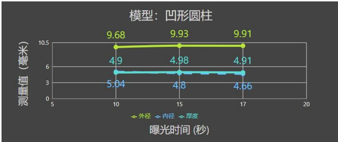
从凹形圆柱数据来看，曝光时间对厚度同样影响不大，但曝光时间不足，凹陷部位固化不够，导致内直径向外扩张，相反曝光过量，凹陷部位持续固化，导致内直径收缩。
