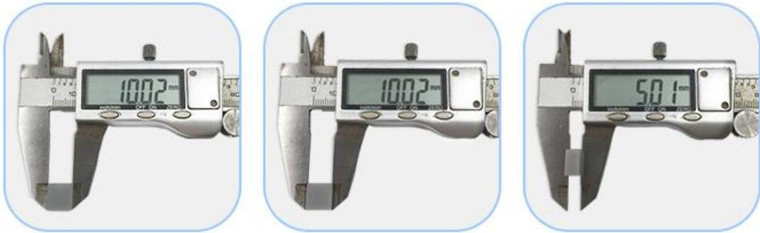
第一次测试，数据误差可以接受，特别是方块数据误差，圆柱孔、轴呈紧配合状态（相差-0.02mm）。
