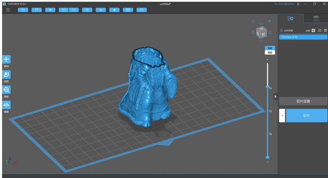
CHITUBOX 提供了一个简单的工具，用于在您的镂空模型表面上打孔，只需点击几下即可完成工作。
