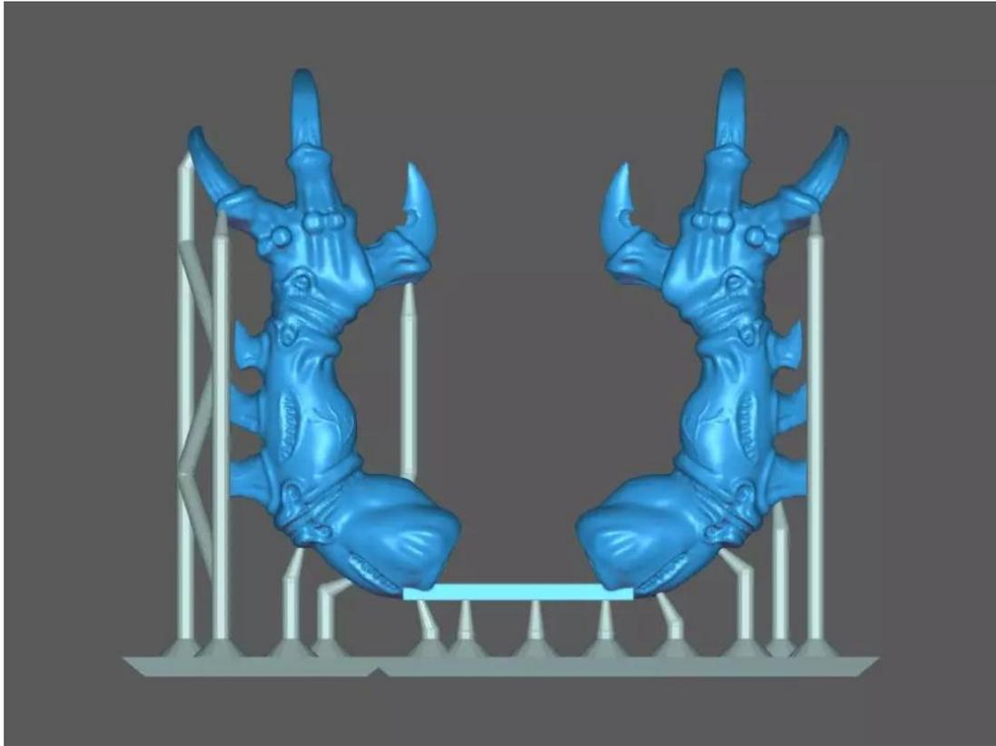
在结构稳定的前提下，更少的支撑为可以带来更平滑的打印表面，减少后处理工作量。
